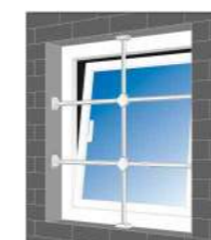
Montaggio nella spalla
