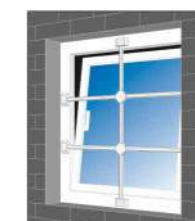
Montaggio sul telaio finestra
