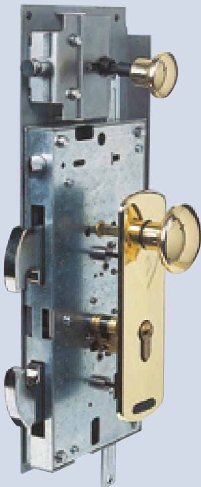
**GRIPSTOP** è l'innovativa serratura di altissima sicurezza brevettata da Tesio Porte. In Gripstop i comuni chiavistelli scorrevoli sono sostituiti da due ganasce contrapposte in acciaio che, con una rotazione di 90°, si agganciano solidamente al telaio, garantendo così un elevatissimo indice di antiscardinamento.
