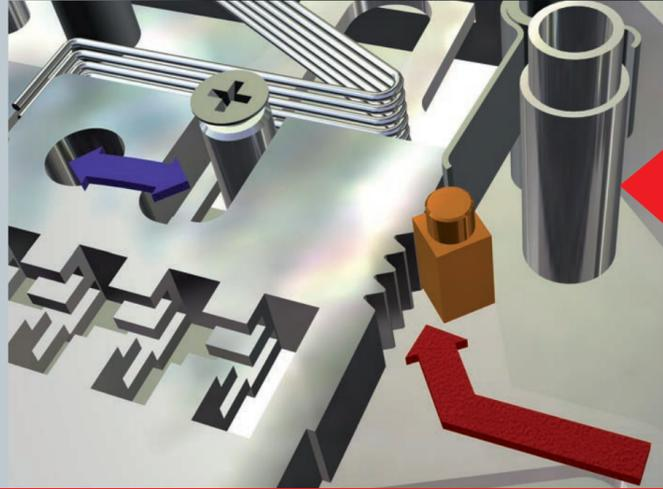
Il dispositivo NO WAY® è un innovativo sistema di protezione delle serrature a doppia mappa concepito per opporsi ai più recenti metodi di apertura per manipolazione e rappresenta una vera barriera antintrusione.
