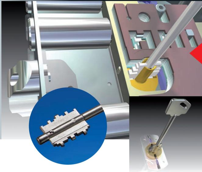
In aggiunta al dispositivo NO WAY®, il sistema MRX PLUS® integra nella chiave a doppia mappa un inserto magnetico ed un elemento sferico mobile che vengono letti e decodificati dalla serratura all'inserimento della chiave stessa, consentendo o impedendone l'azionamento del sistema di chiusura.
