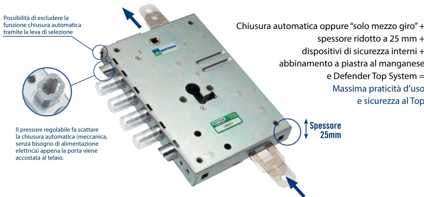
Lo spessore ridotto di 25 mm permette di inserire la piastra di protezione al manganese con Defender Ø 50 TOP SYSTEM, per aumentare al massimo livello la resistenza ai tentativi di effrazione e scasso. Rende possibile inoltre l'inserimento di pannelli ignifughi, fonoassorbenti o termoisolanti.
